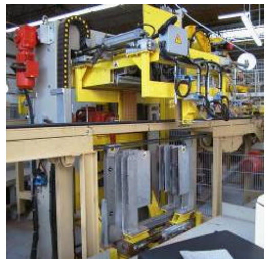
Dachziegelumreifung mit Ausrichter
