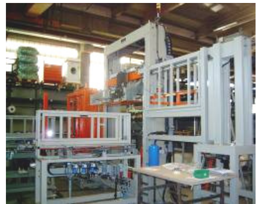
Mit Klotzeinleger und Deckbrettaufleger
