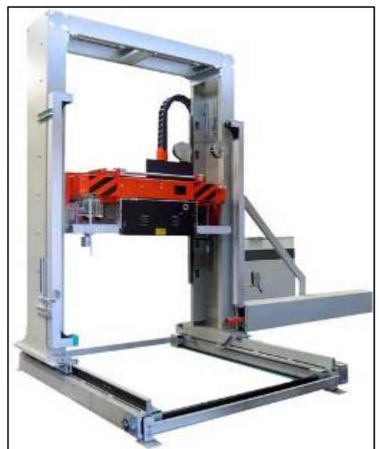
Umreifungspositionierung durch Verfahrbarkeit
