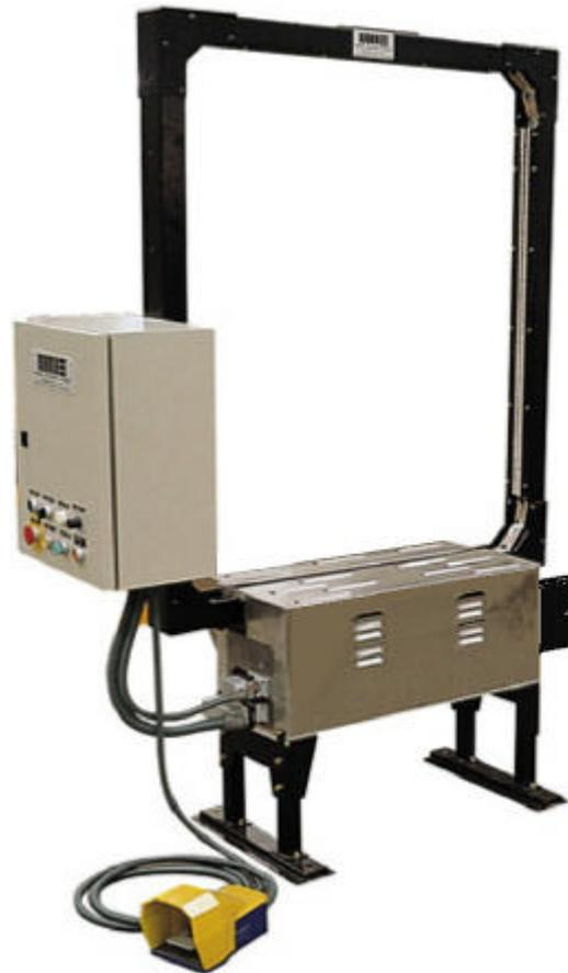
eine technisch durchdachte und ausgereifte Serie von robusten und leistungsstarken Maschinen. Die **OMS** Umreifungsaggregaten sind auf minimale Baubreite ausgelegt. Diese Maschinen eignen sich besonders für den Einbau in automatische Förderstrecken. Vielseitig einsetzbar und mit einer grossen Anzahl ausgereifter optionaler Vorrichtungen, die auf die Bedürfnisse Ihrer Produktion abgestimmt werden. Ein Produkt der
