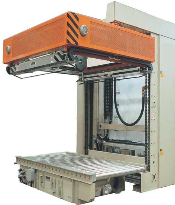
Der OMS Haubenschrapper des Typs AT53 ist eine besonders wirtschaftliche Art der Transportsicherung mittels einer Haube aus Schrumpffolie.
