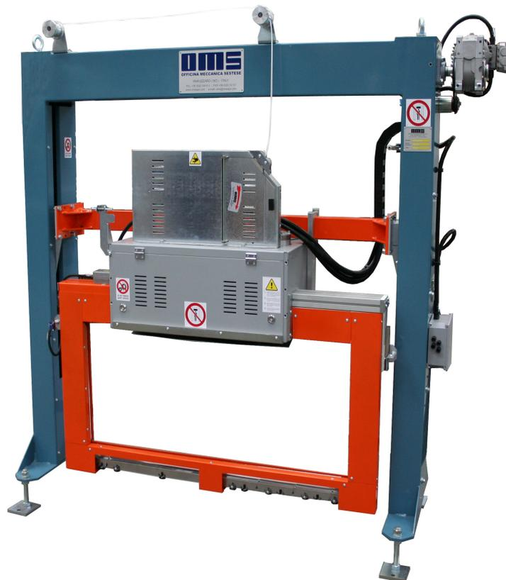
Eine technisch durchdachte und ausgereifte 2-Säulen-Konstruktion mit einem robusten Stirnradtriebemotor mit Bremse für die Bewegung des Auslegerkastens mit dem OMS Umreifungsaggregat und dem Bandführungsrahmen, spielestellbare Stützrollen sorgen für einen verkantungsfreien Leichtlauf des im Maschinenportal verfahrenen Auslegers.
