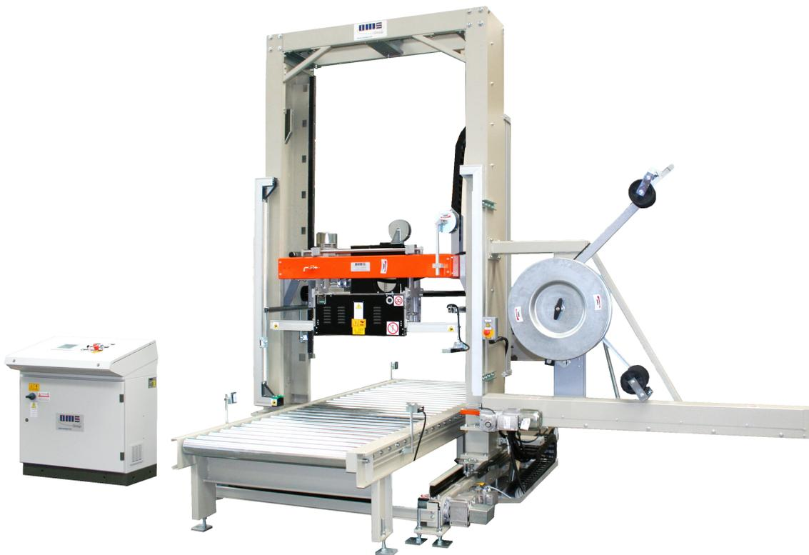
Eine technisch durchdachte und ausgereifte 2-Säulen-Konstruktion mit einem robusten Stirnradgetriebemotor mit Bremse für die Bewegung des Auslegerkastens mit dem OMS Umreifungsaggregat und dem Bandführungsrahmen, spielestellbare Stützrollen sorgen für einen verkantungsfreien Leichtlauf des im Maschinenportal verfahrenen Auslegers.
